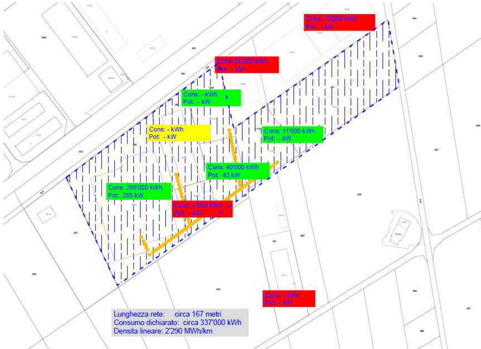
Figura 9: Ipotesi di layout della rete di teleriscaldamento della porzione sud dell'area industriale di Lumino + gli edifici industriali ad Arbedo Castione, in blu il perimetro dei mappali interessati, in giallo la rete. Le etichette per i vari edifici sono colorate in funzione del contenuto dei questionari (verde sì, giallo non si sa, rosso no). In azzurro le etichette degli edifici industriali di Arbedo Castione da verificare.
